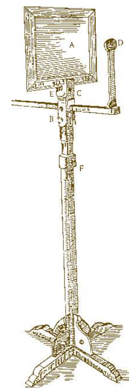
Simon Stevin. Aparato portátil para dibujar sobre vidrio. 1605.
